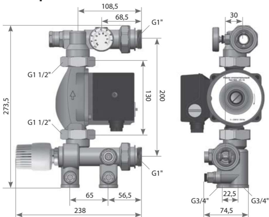
Рис. 8 Габаритные размеры смесительного узла Neptun IWS
